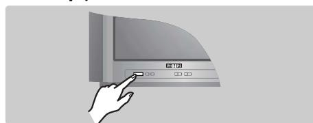
Για να ανάψετε την τηλεόραση, πιέστε το κουμπί λειτουργίας/διακοπής (ON/OFF). Σότε ανάβει μια κόκκινη λυχνία και φωτίζεται η οθόνη. Διαβάστε αμέσως το κεφάλαιο Γρήγορη εγκατάσταση στην επόμενη σελίδα. Αν η τηλεόραση βρίσκεται σε κατάσταση αναμονής, πιέστε το πλήκτρο Q (+) του τηλεχειριστηρίου. Η λυχνία αναβοσβήνει όταν χρησιμοποιείτε το τηλεχειριστήριο.
