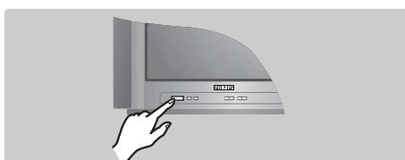
Mit der Taste **EIN/AUS** wird das Fernsehgerät eingeschaltet. Die rote Kontrolllampe leuchtet auf und der Bildschirm wird hell. Lesen Sie jetzt das Kapitel Schnellinstallation auf der Seite 4. Sollte das Fernsehgerät im Bereitschaftsmodus bleiben, drücken Sie die Taste **P (+)** auf der **Fernbedienung**. Wenn Sie die Fernbedienung verwenden, blinkt die Kontrolllampe auf.
